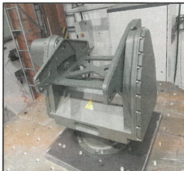
Figures 2, 3: EUT (Z test axis orientation)
